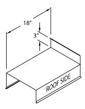
ENDWALL FLASHING COPING VERSION (RIGHT HAND SHOWN)
